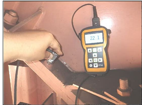
【超音波厚さ計による部材厚測定】
